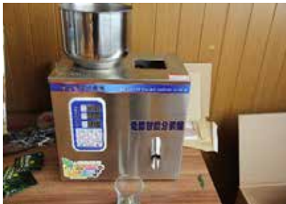
Fotografija 10.3: Strojček za pakiranje zeliščnih mešanic in vrečke za proizvod Kronica, najdeno v proizvodnih prostorih v Ljubljani
