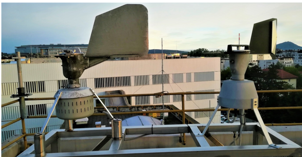
Slika 1. Merilna postaja v Ljubljani z dvema vzorčevalnikoma Hirstovega tipa (foto: Tom Koritnik)
